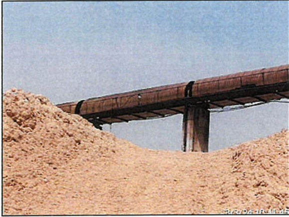
รูปที่ 4 ระบบสายพานลำเลียงแบบปิด
