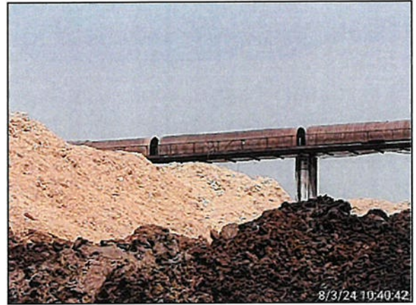
รูปที่ 4 ระบบสายพานลำเลียงแบบปิด
