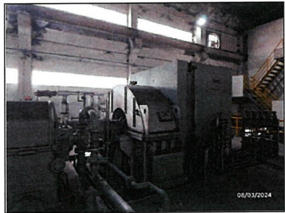
รูปที่ 24 การปิดครอบเครื่องจักรอุปกรณ์ที่มีเสียงดัง
